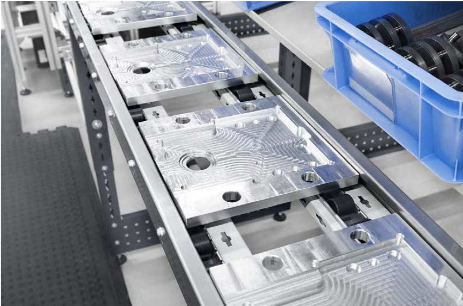
Sorgen Sie für einen reibungslosen und effizienten Materialfluss mit **avero** Transportlinien. Der Werkstückträger rollt sanft über die Rollenbahnen des **avero** Arbeitsplatzsystems von Montagesegment zu Montagesegment.
